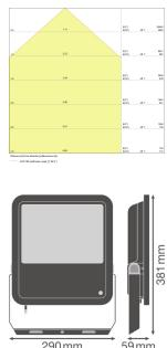
**Scheda tecnica Ledvance Proiettore LED Photocell GEN 3 Nero 125W 15000lm 100D - 840 Bianco Freddo | IP65 - Sensore di luce - Simmetrico**
